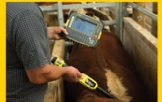
Lectura automática de IDE a través del bastón XRS
